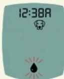
3. La pantalla muestra la hora, el símbolo del animal y una gota que parpadea. Asegúrese de que el símbolo del animal coincida con el animal al que le hará la prueba (para obtener información sobre cómo cambiar el tipo de animal, consulte la sección Configuración/Cambio del tipo de animal).
