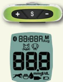
Comience con el medidor apagado (sin insertar la tira de prueba). Presione y mantenga presionado el botón **(S)** durante al menos 5 segundos hasta que aparezca la pantalla completa y el medidor emita un pitido varias veces. Suelte el botón **(S)**. Aparecerá la hora.
