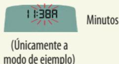
**Configuración de la hora:** La hora parpadea primero. Presione el botón **(S)** si la hora es correcta o presione **(+)** o **(-)** para deslizarse hacia adelante o hacia atrás hasta cambiar al número correcto. Siga presionando el botón **(+)** o **(-)** hasta que aparezca **A** (para AM) o **P** (para PM) junto a la hora. Presione el botón **(S)** para guardar. El medidor emite pitidos y los minutos comienzan a parpadear.
